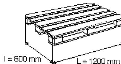
Il materiale se consegnato su pallet dovrà essere protetto da pioggia e polvere mediante l'applicazione di una pellicola di plastica trasparente
